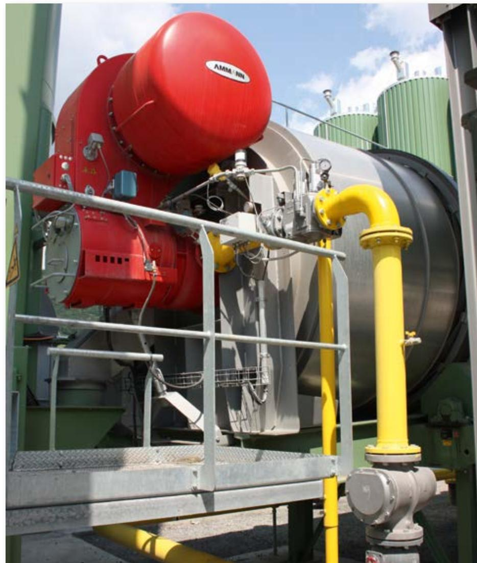
Camandona à St-Triphon : four tambour sécheur d'une puissance thermique de 13,9 MW
